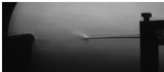
Abbildung 1: Vorläufiges Schlieren Bild einer Corona Entladung
